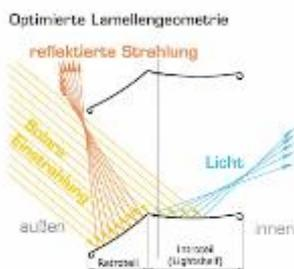
*Die RETROLux-Lamelle besteht aus zwei Teilstücken: Der außenliegende Teil reflektiert die direkten Sonnenstrahlen zurück in den Himmel und lässt die Hitze gar nicht erst an die Fensterscheibe heran. Das nach innen orientierte Segment hingegen lenkt das Tageslicht blendfrei über die Decke tief in den Raum.*
