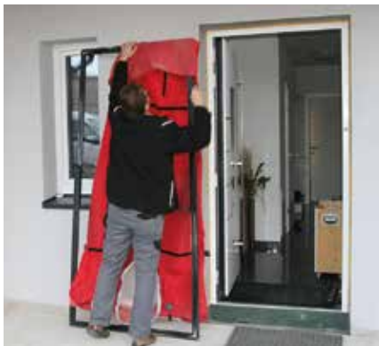
Abb. 10 | Messgerätschaft für den Blower-Door-Test. © vöZ
