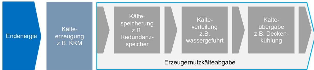
Abbildung 80: Schematische Darstellung der Komponenten eines Gebäudekühlsystems; Quelle: eigene Darstellung
