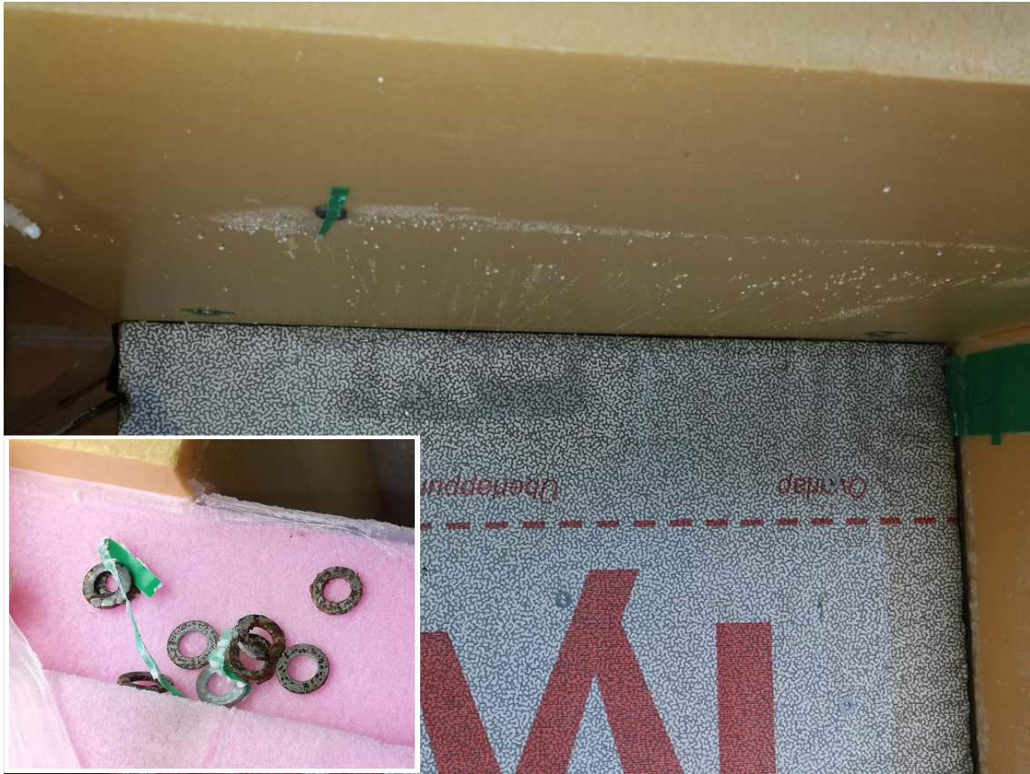
Abb. 3.6: Kondensat und verrostete Schrauben bei Kleinversuch mit Dampfbremse mit geringem s_d -Wert
