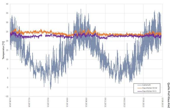
Unabhängig von den Außentemperaturen konnte die Temperaturkonstanz selbst über 2 Jahre extrem hochgehalten werden. Der Unterschied zwischen Oberflächentemperatur der thermisch aktivierten Decke und der Raumtemperatur blieb dabei kleiner als 0,7 Kelvin.
