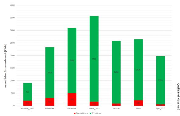
Die Monatssummen des Stromverbrauches der für das Wohnhaus genutzten Wärmepumpe in der Heizsaison 2021/22 zeigen, dass ein Großteil des Verbrauches mittels Windstrom gedeckt werden konnte. Das Windsignal wurde im Oktober 2021 eingeführt und war anfangs noch mit technischen Problemen behaftet. Somit sind die Monate des Jahres 2022 repräsentativer für den tatsächlichen Verbrauch.
