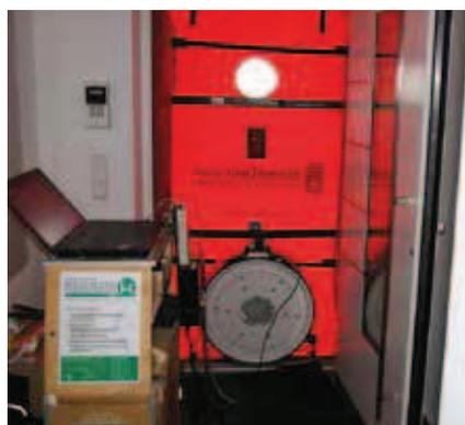
**Abb. 10** | Messgerätschaft für den Blower-Door-Test. © vöz
