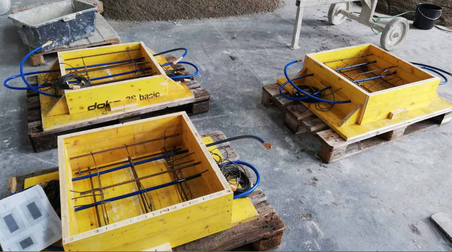
Foto: FH Salzburg, betonierte Prüflinge
